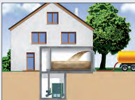
Esempio: magazzino pellet con dispositivo di aspirazione
