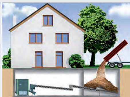
Esempio: trasporto del combustibile da un magazzino di deposito lontano tramite una seconda coclea
