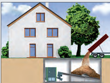
Esempio: magazzino interrato con tetto transitabile
