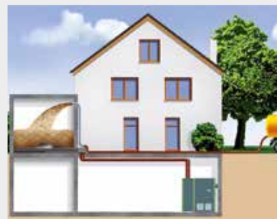
Beispiel: Vom Heizraum entfernter Lagerraum – Transport der Pellets mit HDG Pellet-Saugsystem
