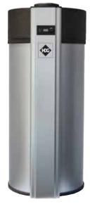
Die HDG Brauchwasser-Wärmepumpe BRWP 300 (ES) ermöglicht die flexible und kostengünstige Erwärmung des Brauchwassers. Sie kann eine Photovoltaik-Anlage einbinden und wandelt praktisch den selbst produzierten Strom in Wärme um. Die Brauchwasser-Wärmepumpe saugt Umgebungsluft an und stößt kühlere trockenere Luft aus. Dadurch ist eine Entfeuchtung von Kellerräumen bzw. auch eine Klimatisierung von Räumen möglich.
