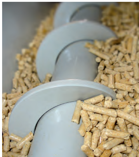
La vis de l'extracteur de granulés HDG transporte les granulés à partir des espaces de stockage rectangulaires.
