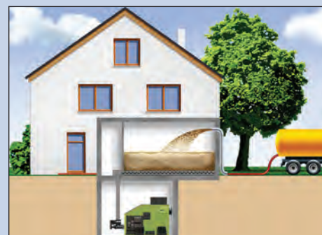
Exemple : silo de stockage des granulés dans la cave avec dispositif d'insufflation
