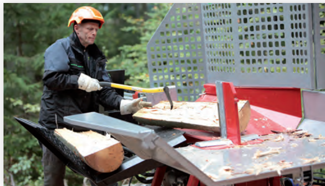
Brennholz sollte zwecks Trocknung möglichst rasch nach der Ernte gespalten werden, dafür gibt es verschiedenste Spaltmaschinen.
