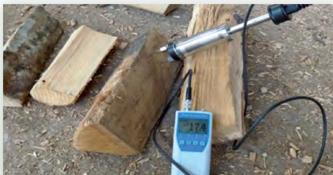
Per Feuchtigkeitsmessung lässt sich ermitteln, ob das Holz schon trocken genug zum Einlagern ist.
