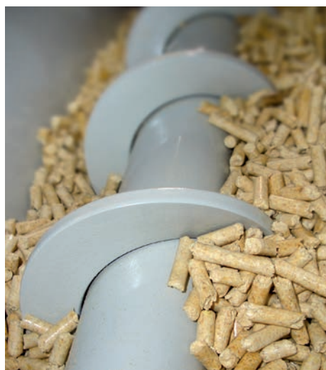
La coclea di raccolta pellet trasporta i pellet dai depositi rettangolari.
