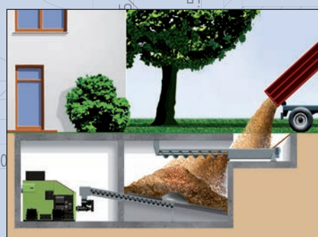
Esempio: Deposito combustibile con coclea di introduzione tramite bocca di lupo
