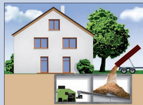
Esempio: Deposito combustibile interrato con solaio transitabile
