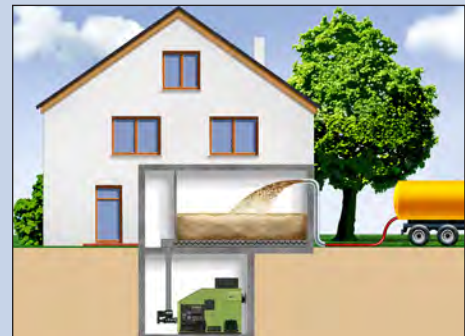
Beispiel: Pelletlagerraum mit Einblasvorrichtung
