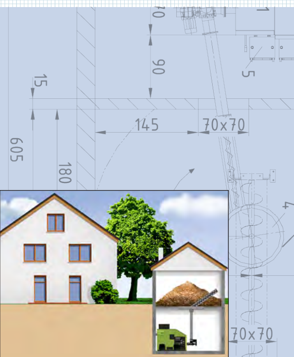
Beispiel: Siloaustragung aus einem Spänesilo mittels Schrägschnecken-Austragung
