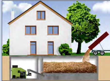
Beispiel: Schubboden-Raumaustragung mit Befüllung über befahrbare Decke
