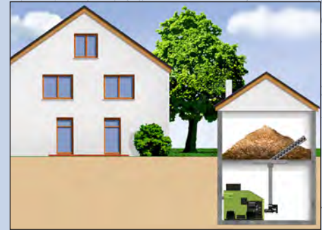
Beispiel: Siloaustragung aus einem Spänesilo mittels Schrägschnecken-Austragung
