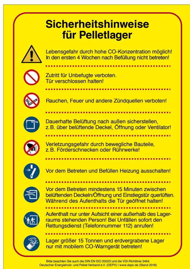
Abb. 32: Aufkleber mit Sicherheitshinweisen für den Zugang zum Lagerraum
